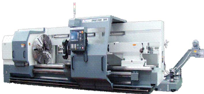
Произведенные корпорацией Dalian Machine Tool Group, **тяжелые токарные станки с ЧПУ** модели SKE61100M предназначены для обработки крупных заготовок типа тела вращения длиной до 8 м, со ступенчатыми цилиндрическими,
