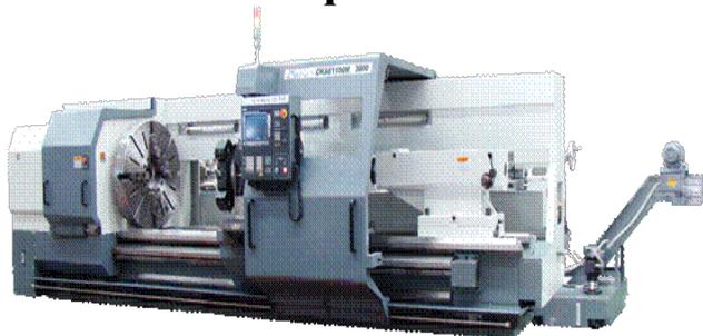
Токарный станок модели СKE611250M является специальным оборудованием предназначенным для обработки больших и тяжелых деталей. Длина обрабатываемой детали может достигать до 8 метров, а вес 5000 кг. Обработка таких крупных заготовок достигается за счет широкой станины (перемещение по оси X составляет 640 мм) и возможностью поддержки детали в нескольких
